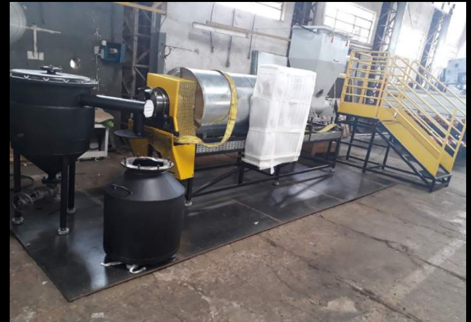
Fabricação de Protótipo Forno rotativo Biodigestor
