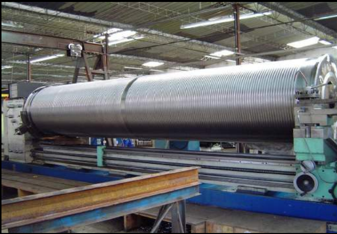
USINAGEM DE TAMBOR DE ELEVAÇÃO DE PONTE ROLANTE D 1250 X 6000 8 TON
